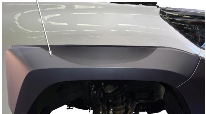
Remove Fender Flare
